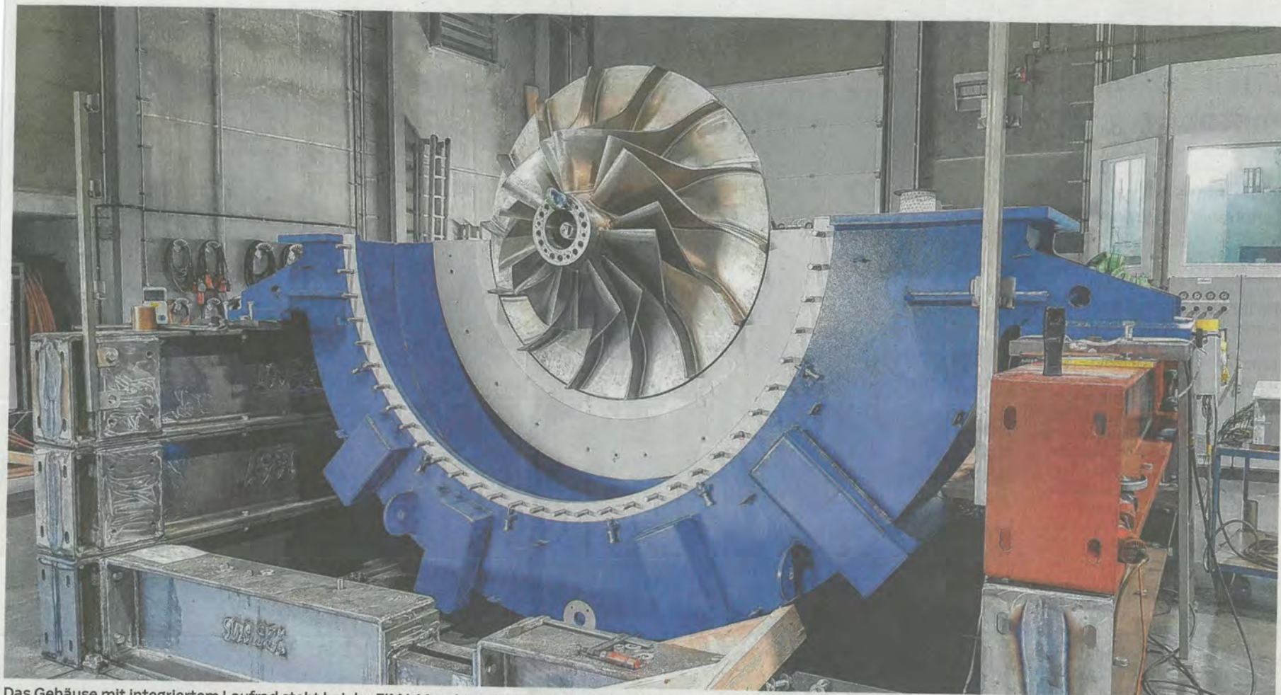
Das Gehäuse mit integriertem Laufrad steht bei der FIMA Maschinenbau im Prüffeld für die bevorstehenden Testläufe bereit. Im teilmontierten Zustand ist das aus einem Metallblock gefräste Laufrad mit 1,6 Metern Durchmesser gut zu erkennen.
